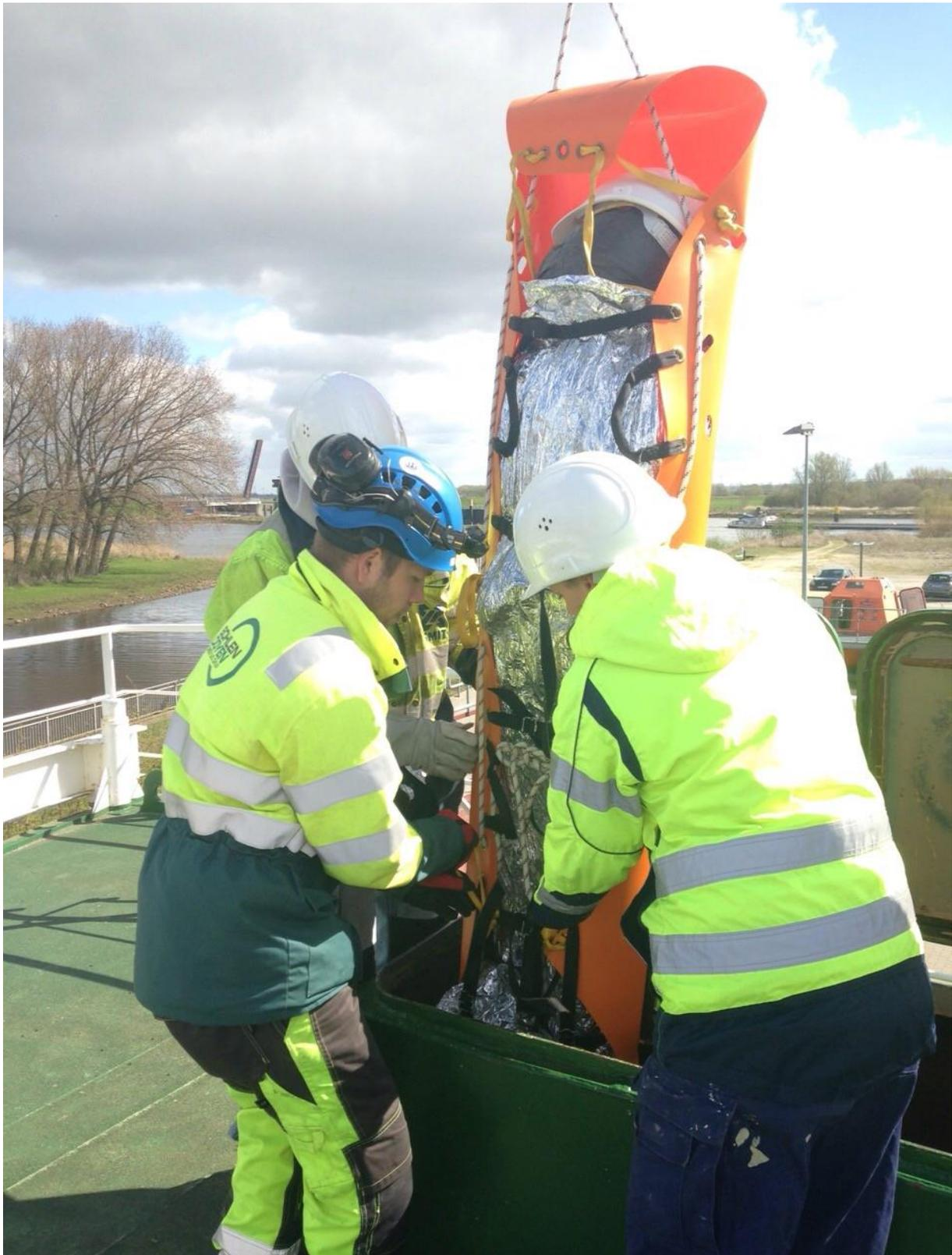
Im zweiten Untersuchungsgang wurde das SK 650-Rapid Deployment System zur Evakuierung mit einem Trainingsdummy (110kg) und Zusatzgewichten bis zum BMI von 35 - 40 kg/m<sup>2</sup> im Maritimen Kompetenzzentrum Elsbeth an einem Schiffsmodell mit Schoten und Niedergängen getestet. Die gegebene Enge der Räume wurden die Untersuchungsvoraussetzungen geschaffen. Nach Fixierung wurde der Dummy durch einen
